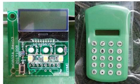
ボタン照明用 LED 打ち込み、スイッチはインパネ面より距離を稼ぐため、足を折り曲げて裏から取付、ボタンはオフセットして付けてあります。左斜め下の黒い物がリセットスイッチ。
