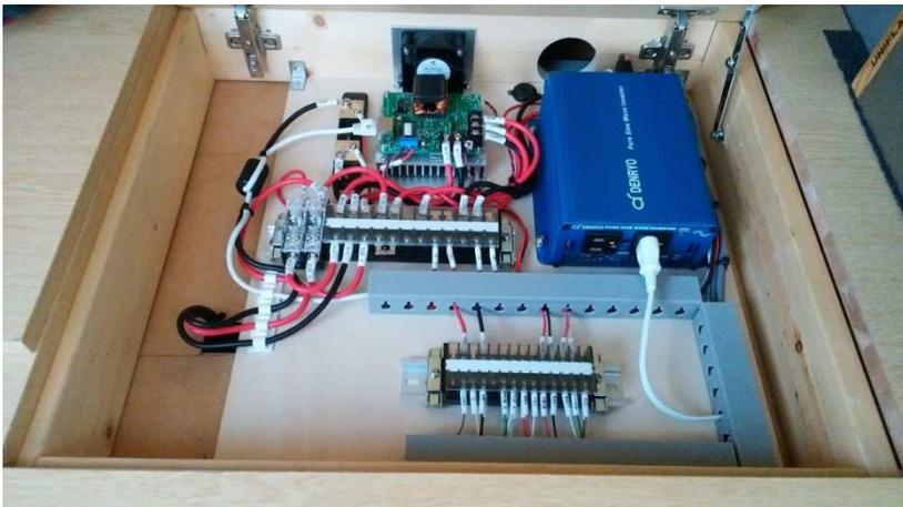
350W インバータは、TC10B の発熱を考慮してバッテリー直結、インバータのコントロール信号を TC10 の出力側から取る事で出力遮断時、インバータ OFF となります。インバータ SK350 のアイドリング電流は 700mA 程度です。ロスが多いですが、電気毛布、ミニ炊飯器使用の為やむなく。
